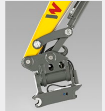
Powertilt s hydraulickým rýchlopínáčom Easy Lock.
