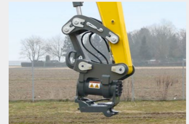
Powertilt s hydraulickým rýchlopínáčom Easy Lock.
