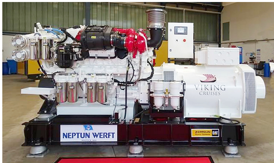
Spaľovací motor Cat C32 ACERT s výkonom 994 kW tvorí súčasť koncepcie dieselelektrického pohonu lode.
